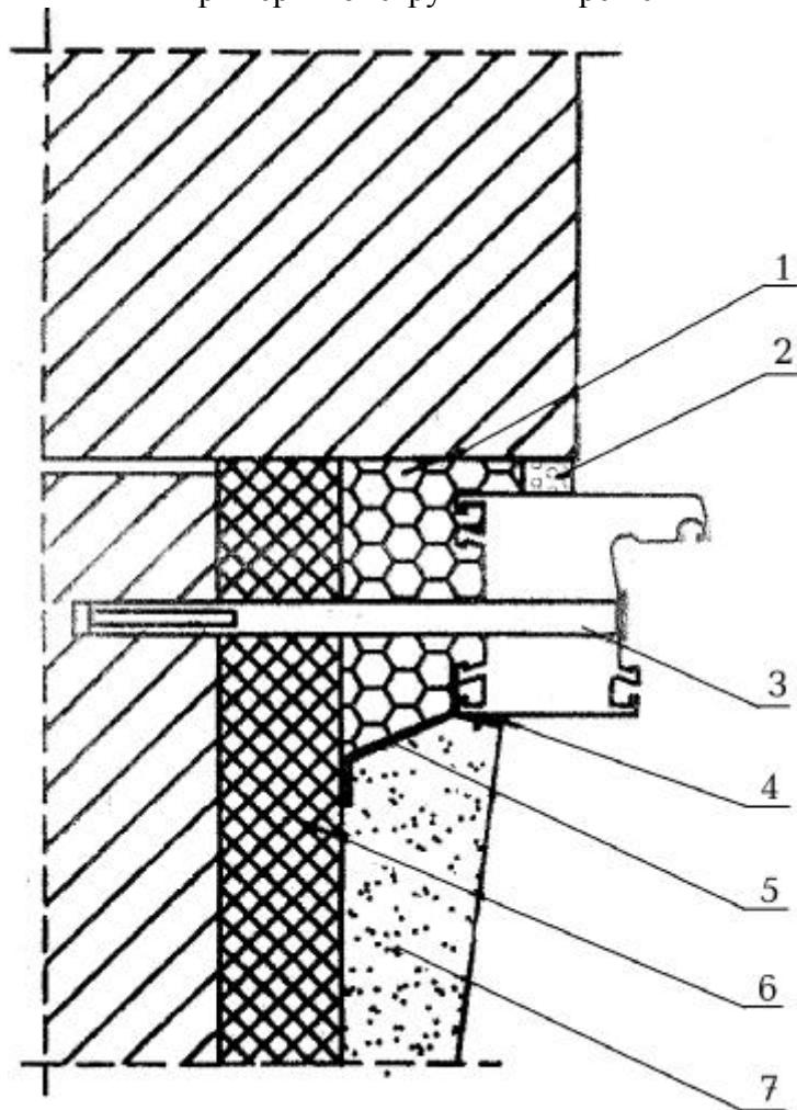
1 - пенный утеплитель; 2 - изоляционная саморасширяющаяся паропроницаемая лента; 3 – рамный дюбель; 4 – герметик; 5 – пароизоляционная лента; 6 – компенсатор монтажного зазора (может применяться для утепления откоса и изоляции пенного утеплителя от плоскости возможной конденсации); 7 – штукатурный слой внутреннего откоса (с фаской для слоя герметика)
