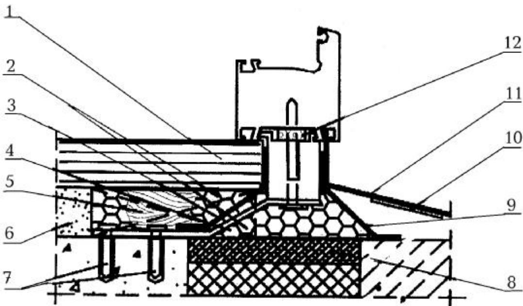
1 – подоконная доска; 2 – пенный утеплитель; 3 – пароизоляционная лента; 4 – гибкая анкерная пластина; 5 – опорная колодка под подоконную доску; 6 – штукатурный раствор; 7 – дюбель со стопорным шурупом; 8 – вкладыш из антисептированного пиломатериала; 9 – водоизоляционная паропроницаемая лента; 10 – шумопоглощающая прокладка; 11 – слив; 12 – изоляционная саморасширяющаяся паропроницаемая лента
