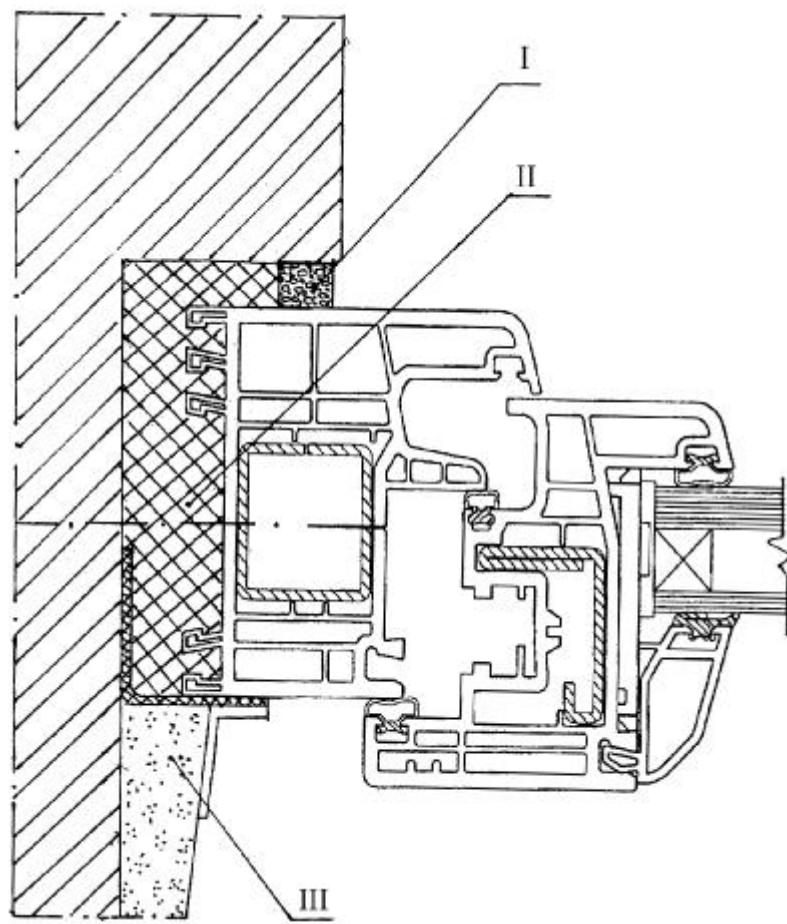
I – наружный водоизоляционный паропроницаемый слой;
