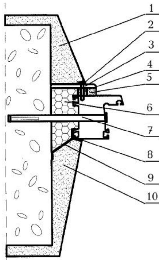
1 – штукатурный слой наружного откоса (с фаской для слоя герметика); 2 – герметик; 3 – нащельник; 4 – дистанционная прокладка (шайба); 5 – изоляционная саморасширяющаяся паропроницаемая лента; 6 – пенный утеплитель; 7 – рамный дюбель; 8 – герметик; 9 – пароизоляционная лента; 10 – штукатурный слой внутреннего откоса (с фаской для слоя герметика)
