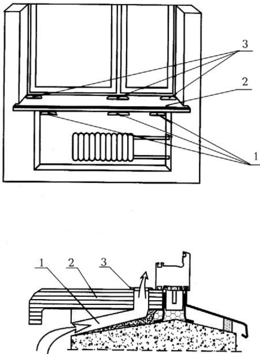
1 – канал подачи теплого воздуха от нагревательного прибора к оконному блоку (штроба в стяжке из штукатурного раствора); 2 – подоконная доска; 3 – декоративная решетка выходного отверстия
