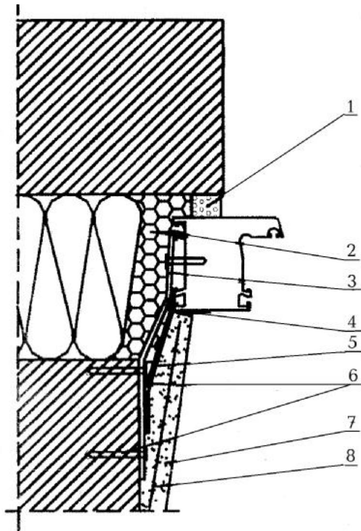
1 – изоляционная саморасширяющаяся паропроницаемая лента; 2 – пенный утеплитель; 3 – гибкая анкерная пластина; 4 – герметик; 5 – пароизоляционная лента; 6 – дюбель со стопорным шурупом; 7 – штукатурный слой внутреннего откоса (с фаской для слоя герметика); 8 – армирующая сетка
