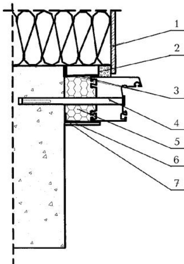
1 – элемент отделки наружного оконного откоса; 2 – изоляционная саморасширяющаяся паропроницаемая лента; 3 – водоизоляционная паропроницаемая лента; 4 – рамный дюбель; 5 – пенный утеплитель; 6 – пароизоляционная лента; 7 – декоративный нащельник
