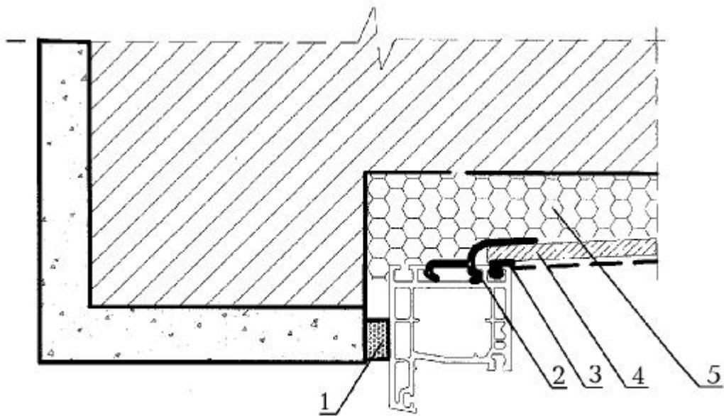
1 – изоляционная саморасширяющаяся паропроницаемая лента; 2 – [дополнительный профиль](#); 3 – [герметик](#); 4 – влагостойкий гипсокартон с пароизоляционным покрытием; 5 – пенный утеплитель
