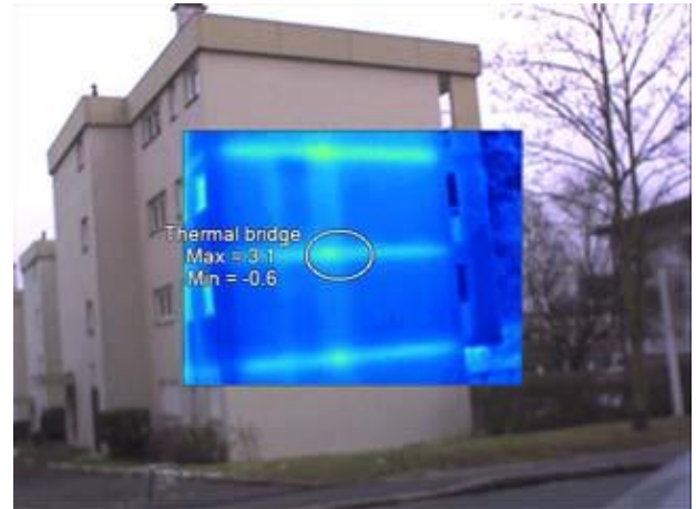
Рис.3 Возможности анализа термограммы FlukeTi3
